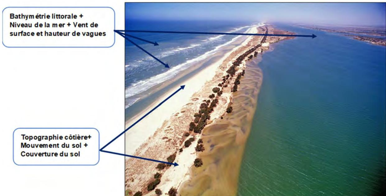
Figure 53 : Zones et paramètres à monitorer par suivi satellitaire (SAR : Sentinel-1/Envisat/ERS-1... ; Imagerie multispectrale : Sentinel-2/Landsat)
