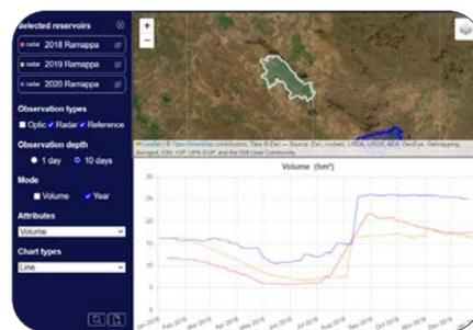
Interface StockWater. Volumes mesurés par radar pour les années 2018 (rouge), 2019 (jaune) et 2020 (bleu) dans le réservoir de Ramappa (Hyderabad, Inde). © SCO/CNES
