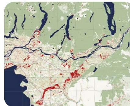
Cartographie rapide d'inondation générée avec l'algorithme FloodML à partir d'images radar Sentinel-1 pour un événement d'inondation sur Seattle (US) et Vancouver (CA) le 16/11/2021. © CNES-CLS
